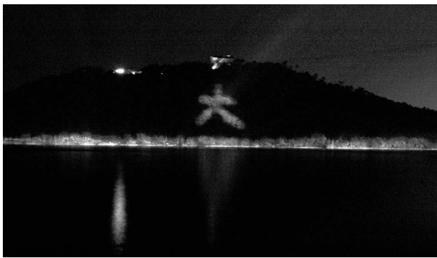
図2 静岡県浜松市西区館山寺町にある大草山の遠隔照明実験。ホロライト 300 台を用いて山の湖畔と中腹に点状パターンを形成。
