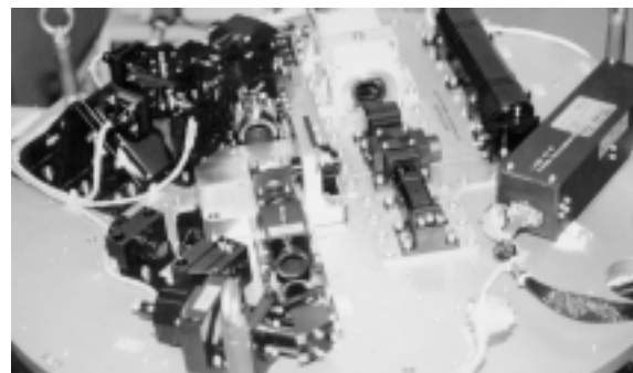
図4 TR-1A ロケット用のリアルタイム位相シフト干渉計とコモンパス干渉計。直交する2方向で使用する。円盤直径は約100cm。
