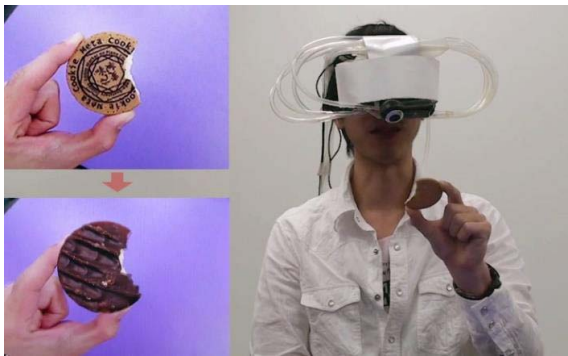
図1 視覚・嗅覚・味覚の感覚間相互作用を利用した味覚提示システム。
