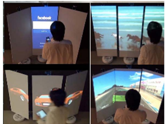
図3 Shape-shifting Wall Display. 移動・変形機能を有するウォールディスプレイの形状例（左上：プライバシーを保護する凹型、右上：横長コンテンツを表示するための平面型、左下：立体感を増強する凸型、右下：没入感を増強する凹型）。
