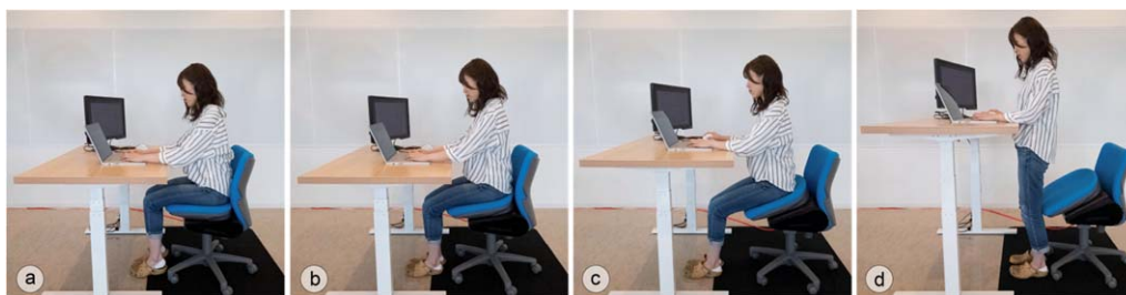
図4 TiltChairによる自然な座位から立位への遷移 (a: 通常座位, b: 座面傾斜開始, c: 座面傾斜角度最大, d: 立位への遷移).
