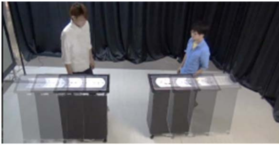
図2 MovemenTable. 移動機能を有するテーブルディスプレイの例.
